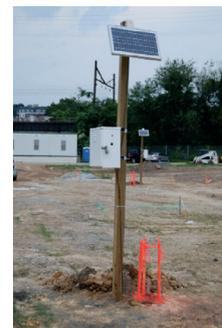
6. Emplacement du géophone en sondage clairement marqué et moniteur placé dans un boîtier bien fermé.
