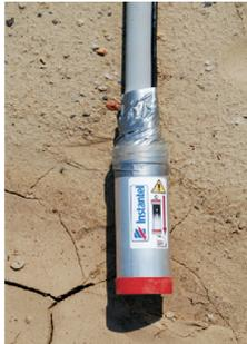
1. Préparez le géophone en sondage en enroulant les raccordements avec du ruban électrique pour qu'ils restent propres.
